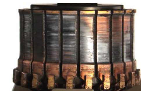
Bilden beskriver en motor med en utsliten kollektor.
