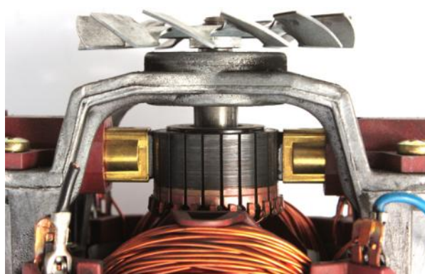
Bilden ovan beskriver en normalt sliten motor.
