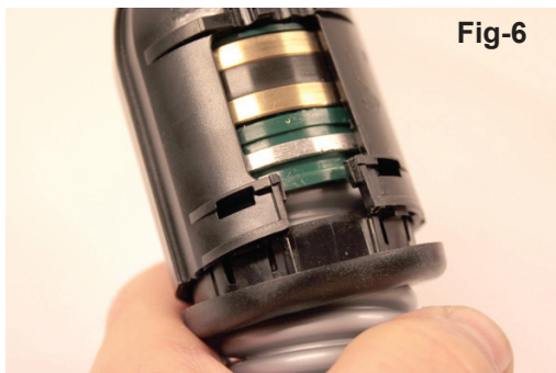
Fig-6. Klickringen har släppt i övre infästningen.
