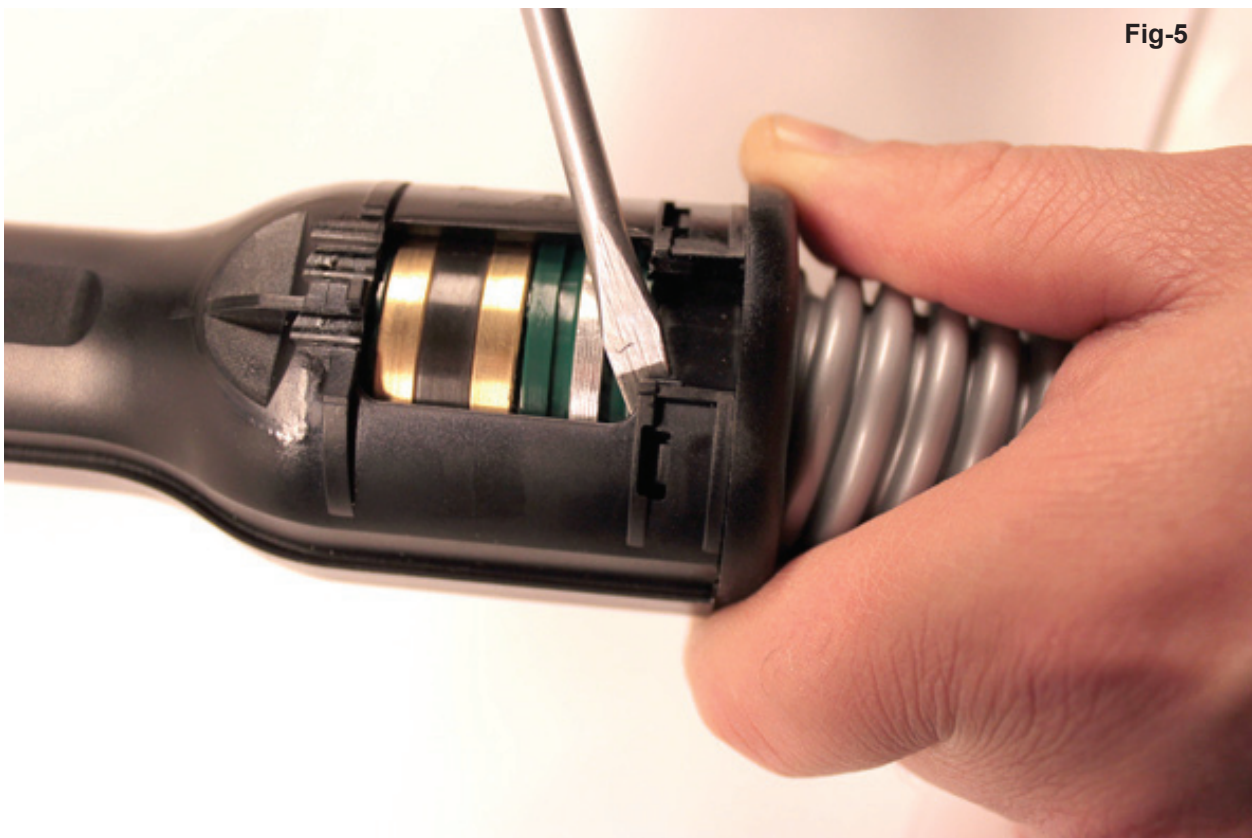
Fig-5. Vik försiktigt upp plastkanten med en skruvmejsel för att lättare frigöra klickringen.
